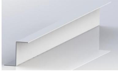
Osim jednostavne montaže i iskoristivost ovih nosača je maksimalna (nema otpatka) u odnosu na klasične valjane profile koji su puno teži i traže antikorozivnu zaštitu koja je po vijeku trajanja puno manja od pocinčanih Z profila. Liming Projekt proizvodi Z-profile u dimenzijama 100x50 mm, 125x50 mm i 150x50 mm u debljinama od 1,00 do 3 mm., duljine do 3000mm.
