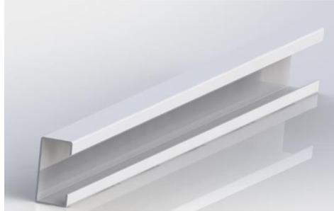
Osim jednostavne montaže i iskoristivost ovih nosača je maksimalna (nema otpatka) u odnosu na klasične valjane profile koji su puno teži i traže antikorozivnu zaštitu koja je po vijeku trajanja puno manja od pocinčanih C profila. Liming Projekt proizvodi C-profile u dimenzijama 100x50 mm, 125x50 mm i 150x50 mm u debljinama od 1,00 do 3 mm., duljine do 3000mm.
